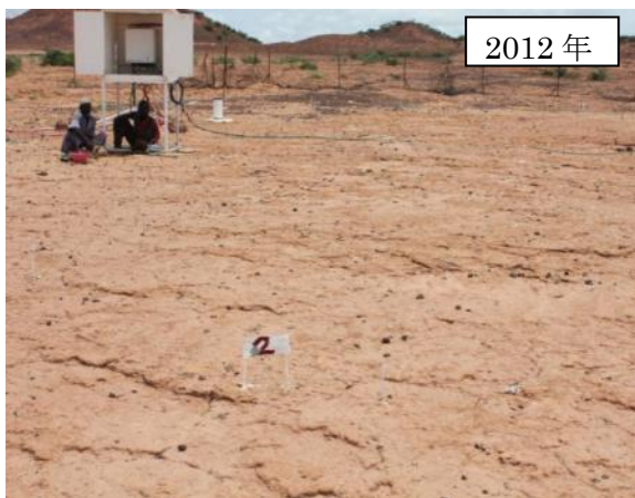
図9 プロット2におけるゴミ投入後の圃場の変化(ゴミの量 5\text{kg/m}^2 )
